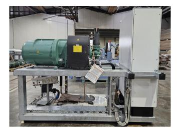
Section 20 Typ CSVH24-125Y-40A S.Nr. 1096701005 BITZER KÜHLMASCHINENBAU GMBH Made in Germany Max. Fördervolum Max. Betriebsstrom Frequenz Nennspannung man V 3Ph~ Hz A 220 380-415 464 50-60 190 440-480 15 / 24 bar IP 54 ND/HD max.
